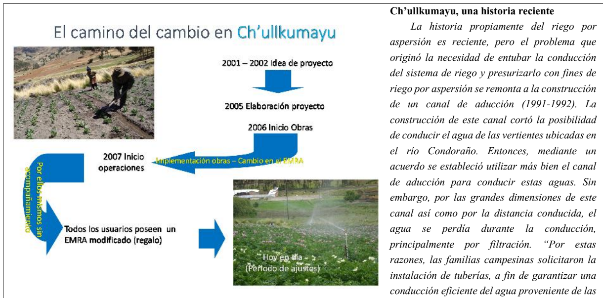
Recuadro 2. Ruta del desarrollo tecnológico en riego en Ch'ullkumayu (Delgadillo y Jiménez, 2011)
