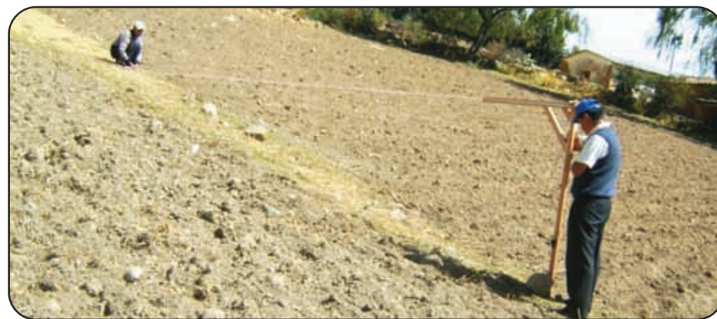
FOTOGRAFÍA 17. MEDICIÓN DE DESNIVELES CON ESCUADRA DE MADERA
