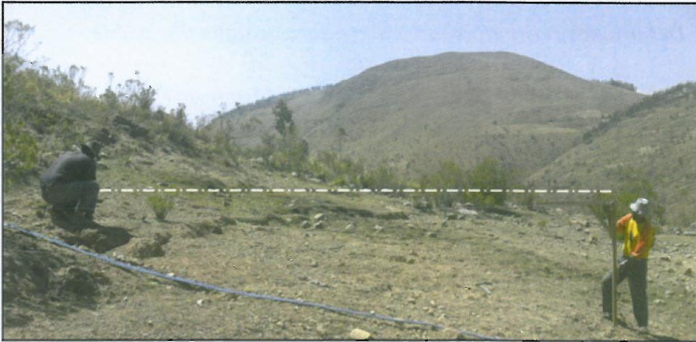
Foto 1. Agricultor determinando el desnivel con ayuda de la escuadra de madera.
